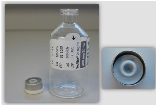
Bilde 2: Hetteglass med gummipropp som løsnet da flip-off-hetten ble tatt av
